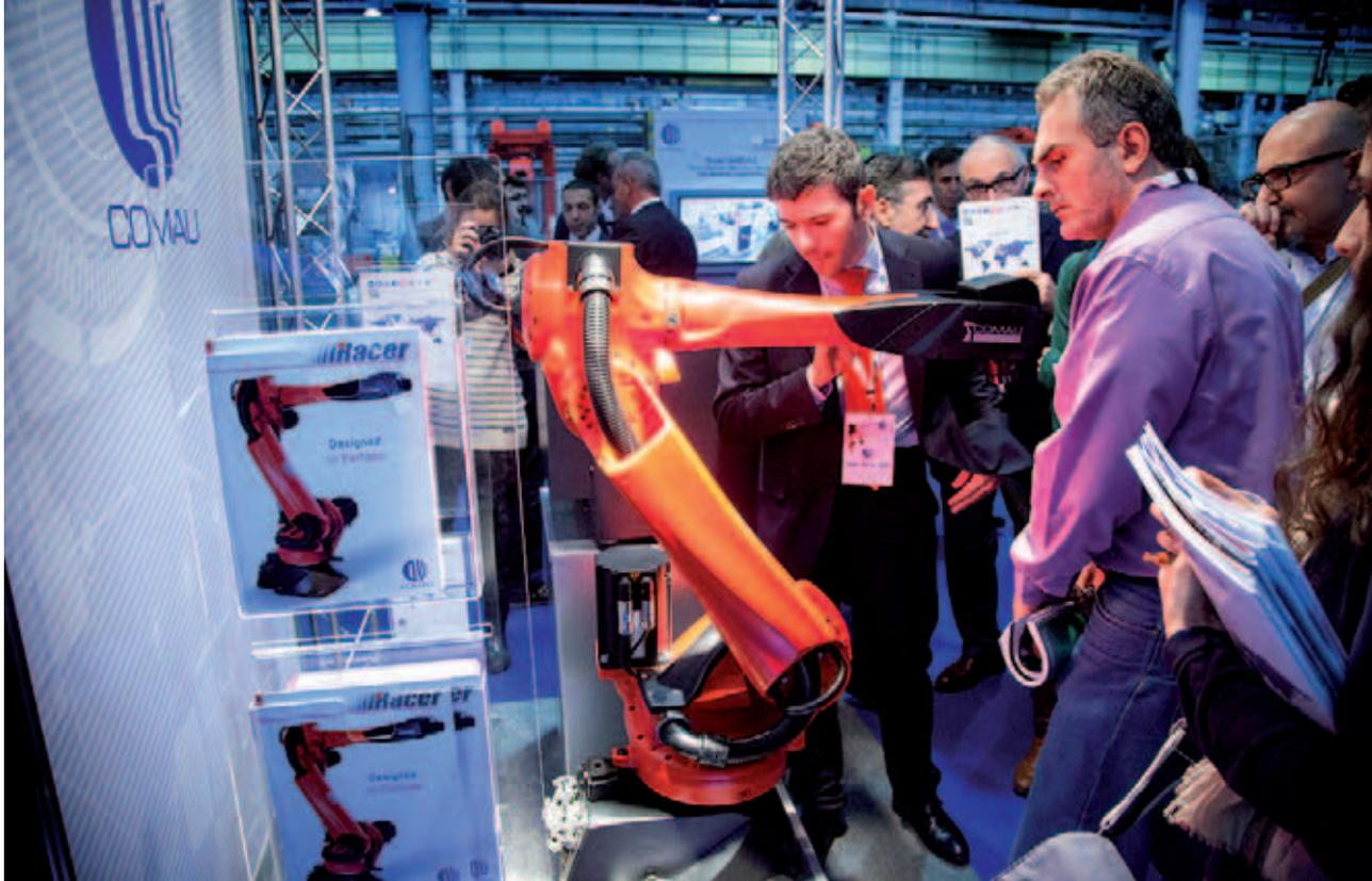
RACER 7-1.4 È IL NUOVISSIMO ROBOT COMAU: 7 KG DI CARICO AL POLSO E SBRACCIO ORIZZONTALE MASSIMO DI 1400 MM. PROGETTATO E REALIZZATO CON TECNOLOGIE AVANZATE, IL ROBOT È IL RISULTATO DI UN'INTENSA ATTIVITÀ DI DESIGN E DI STUDIO DELLE FORME. CON LE SUE DIMENSIONI COMPATTE E LE ELEVATE PRESTAZIONI, SI DISTINGUE PER L'ESTREMA VELOCITÀ.
