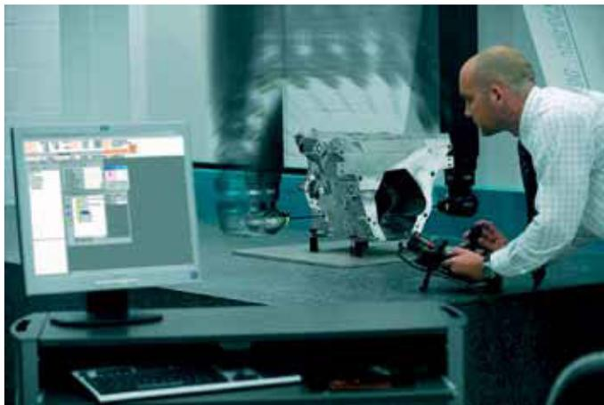
*Per ogni misura effettuata REVO esegue una scansione degli alesaggi e il sistema invia al software i valori acquisiti*
